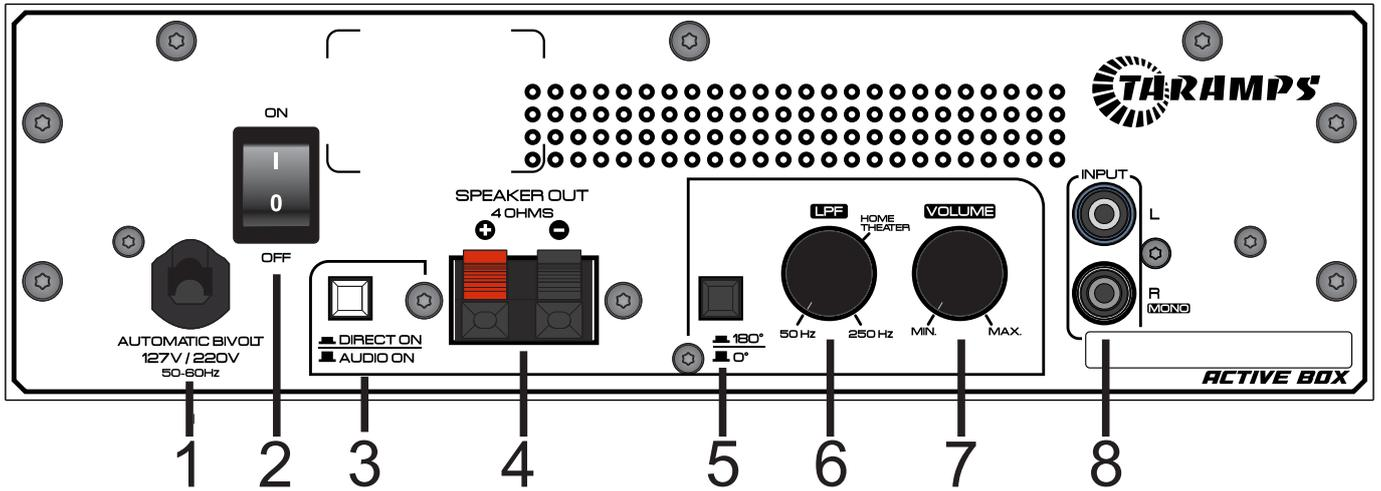
1 - **Cabo de Energia:** Conecte o cabo na rede de energia elétrica. Este produto opera com alimentação entre 90 a 240 VAC.
