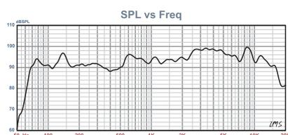
Curva de resosta obtida num box de 25L x 70Hz
