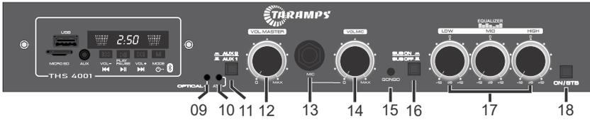
**09 - ÓPTICO:** LED que indica la presencia de una señal óptica. Indica que la entrada auxiliar actual es óptica.
