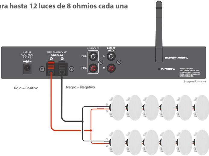
Para este tipo de conexión utilice cables con calibre mínimo de 1,5mm<sup>2</sup> hasta 40 metros. Para distancias más largas, consulte la tabla en la página 02 en "Recomendaciones importantes". Es necesario realizar conexiones en paralelo como se muestra en el ejemplo, para igualar la impedancia. Para otro tipo de proyectos e instalaciones consulte con nuestro soporte técnico.
