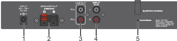
**1 - ENTRADA DE FUENTE DE ALIMENTACIÓN:** Conecte la fuente de alimentación original que viene con el producto.
